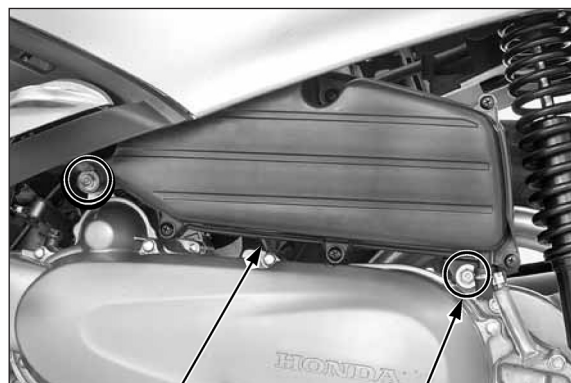
CARCAÇA DO FILTRO DE AR PARAFUSO DA BRAÇADEIRA
